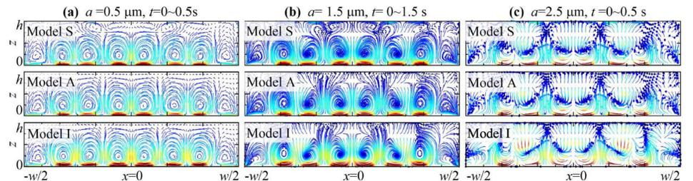
图 4. 图片描述三种模型下不同大小的PS微球在PDMS腔体内的运动轨迹
