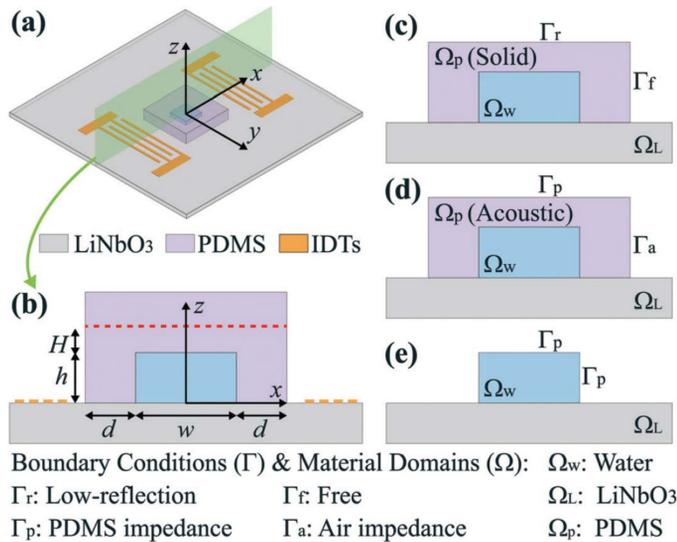
图 1. (a) SAW微流控器件三维示意图, (b)x-z二维截面, (c-e) 使用不同模块处理PDMS腔体, 对SAW微流控器件的x-z截面建模
